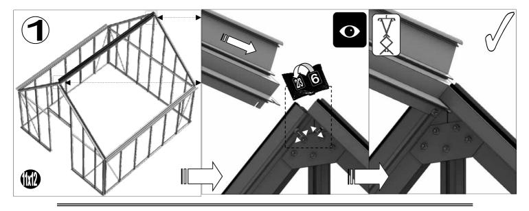
Lijm de nokversiering met een lijmkit vast op de nok. Vrijwel altijd dient u een stuk af te zagen. Gebruik hiervoor een ijzerzaag. De eindstukken worden met kleine schroefjes vast gezet en ook deze kunt u het beste van onder af vast lijmen.
