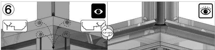
BELANGRIJK: De haakse goot is een gelast onderdeel. Tijdens het lassen kan er vervorming ontstaan in de goot waardoor de gaten niet 100% overeenkomen met de profielen die eraan bevestigd moeten worden. Daarom kan het nodig zijn om ze op te boren zodat ze aansluiten op de DV362 en DV379. Door een 8 mm boor te gebruiken om de standaard 7 mm gaten te vergroten, krijgt u iets meer speling bij het monteren.
