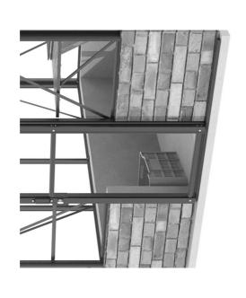
Aan de voorzijde van de kas komt buiten de muur een deurgelijder van 50mm breed op de bodem. Daarom moet er aan de voorzijde ondersteuning zijn (bijvoorbeeld een betonnenrand) die op dezelfde hoogte ligt als de deur.
