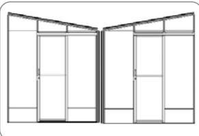
D355 Standard (glissières ouvertures vers la droite) - Porte standard peut être utilisé aux deux extrémités de la serre.
